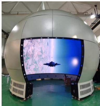
近年来，我公司承担了某部下发的球面 LED 显示屏研究课题，通过集智攻关，获得发明专利、实用新型专利各 1 项，完成工程样品初样试制，达到科研任务书指标要求，2020 年顺利通过验收。2021 年，我公司自筹资金展开了正样研制，新一代产品灯珠采用 Micro LED 封装工艺，灯珠、PCB 板、驱动芯片、解码芯片、存储芯片、FPGA、MCU、箱体结构等器件 100% 国产化，目前 5 米直径、7 米直径的球面 LED 显示屏已具备量产能力，2022 年初，联手成都某公司在成都某主机厂商组织的招标活动中排名第一成功中标。
